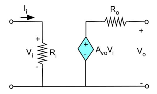
Open Circuit Voltage Gain :
