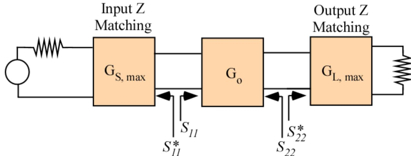
$$G_{U\text{MAX}}(dB) = G_{S\text{ max}}(dB) + G_o(dB) + G_{L\text{max}}(dB)$$
